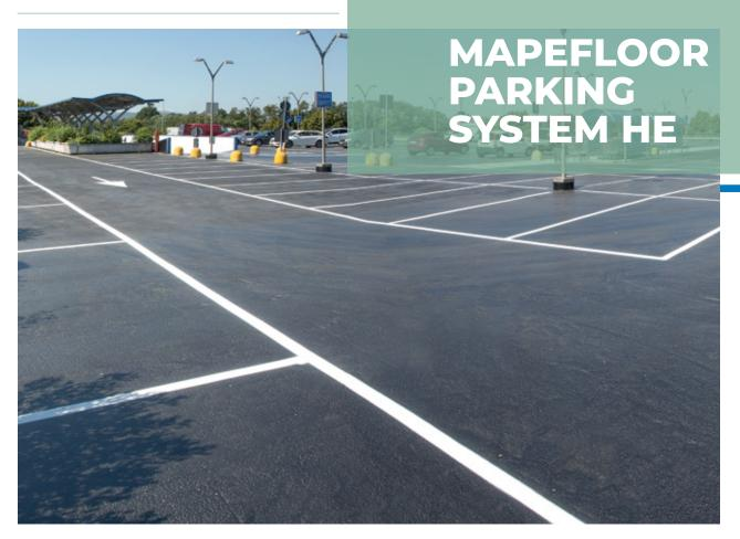
Бесшовное полиуретановое покрытие с отличной способностью к перекрытию динамических трещин для поверхностей с пешеходным и интенсивным автомобильным трафиком внутри и снаружи помещений. Покрытие соответствует требованиям Rili DafStb (Методические рекомендации Немецкого комитета по железобетону), OS 11a. Может применяться для защиты бетонных поверхностей согласно EN 1504-2. Толщина 5-5,5 мм.
