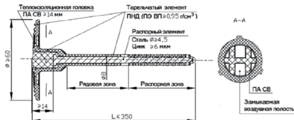
Размер анкера выбирается в зависимости от толщины панели (P), толщины слоя клея (A), присутствия или отсутствия штукатурки (I) и требуемой глубины анкеровки (F).
