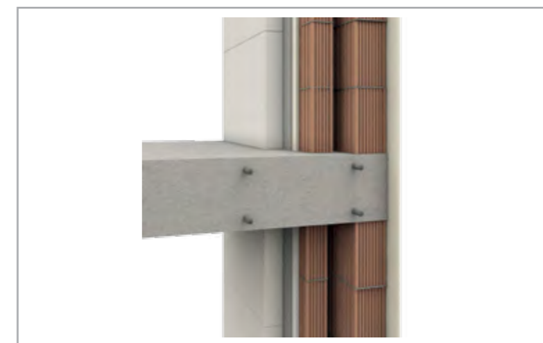
Стратиграфическое представление конструкции с внутренней теплоизоляцией
