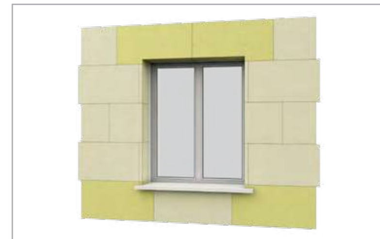
Правильное расположение панелей по периметру проемов
