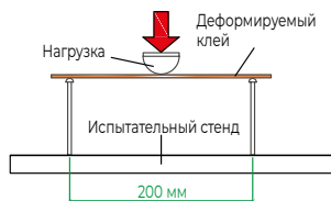
1. Испытательный стенд для измерения эластичности тонкого слоя клея в соответствии с его деформацией
