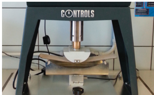
3. Разрушение опытного образца
