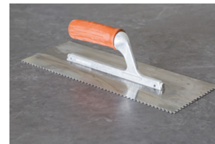
Шпатель со скошенными зубьями для нанесения клеевой растворной смеси на основание и шпатель с квадратными зубьями для обработки тыльной стороны плитки
