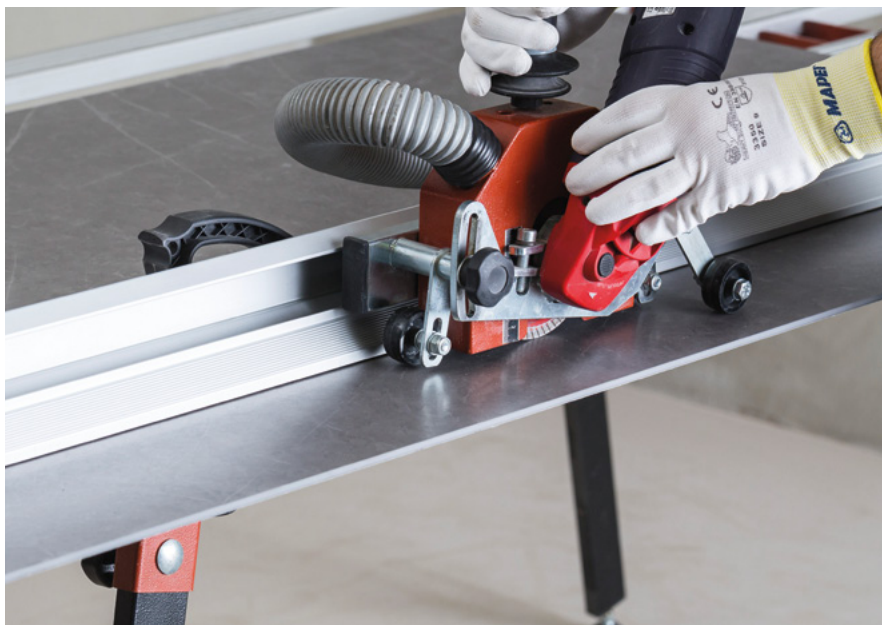
Прямолинейная резка с помощью УШМ
