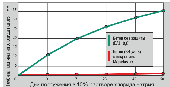
Рисунок 3. Защита бетона с помощью Mapelastic (Мапеластик) от проникновения хлорида натрия
