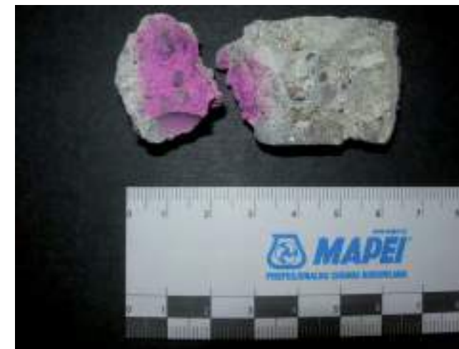
Рис. 5. Цветной тест при помощи фенолфталеина
