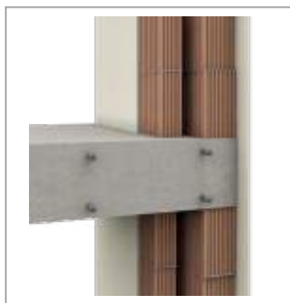
Стратиграфическое представление конструкции без теплоизоляции
