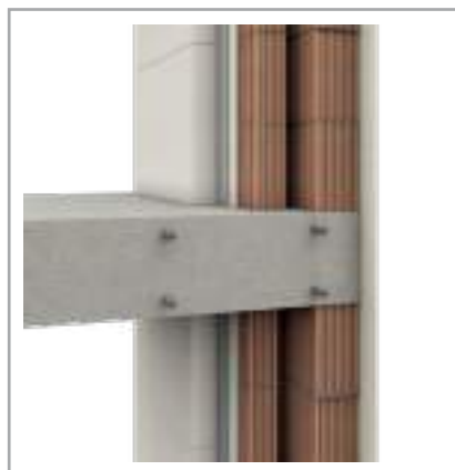
Стратиграфическое представление конструкции с внутренней теплоизоляцией
