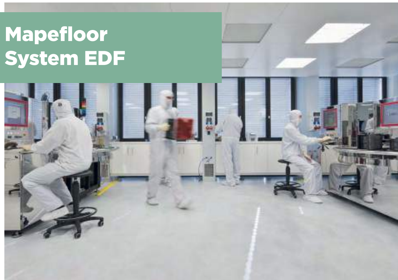
Самовыравнивающееся антистатическое токорассеивающее эпоксидное покрытие для промышленных полов. Толщина 1,5-2 мм.
