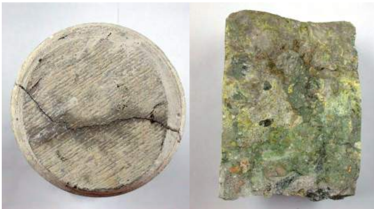
Рис. 12. Образец, взятый из сердцевинки бетона, разрушенной структуры
